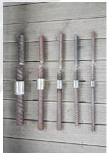
인장 시험 결과 (수출용 커플러 시험 결과)
